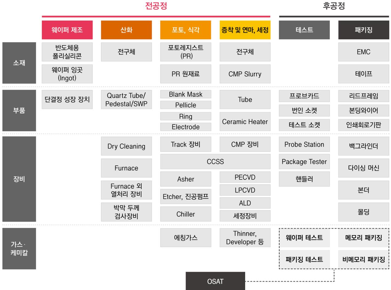
앞서 간략히 살펴본 반도체 제조공정은 각 공정이 고도화 되어 있는 바, 각 공정별로 다양한 소재, 부품 및 장비 산업이 복합적으로 연계되어 있는 모습을 보인다. 본 Section 에서는 전, 후공정 각각에 대해 Value chain 을 구성하는 소재·부품·장비 업체를 중심으로 알아보고자 한다.
